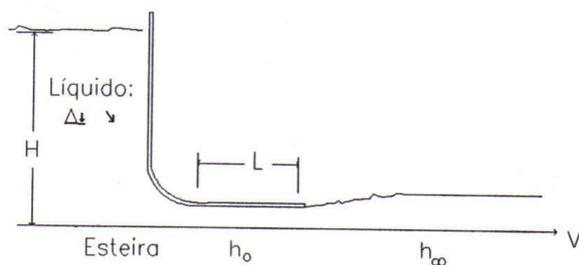
O líquido polimérico possui uma viscosidade  $\mu$  e densidade  $\rho$ . O bocal tem uma altura  $h_0$  e comprimento  $L$ , ( $L \gg h_0$ ).  $P$  é a pressão atmosférica e  $g$  é a aceleração da gravidade. Dependendo do nível de líquido do reservatório a espessura final do líquido na esteira,  $h_\infty$ , pode ser maior ou menor que a altura  $h_0$ . Determine  $H$  tal que  $h_\infty = h_0$  em função de  $V$ ,  $L$ ,  $h_0$ ,  $g$ ,  $\rho$  e  $\mu$ .
