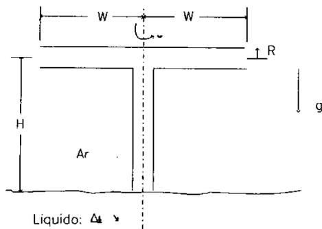
através dos braços. Assumindo um escoamento laminar de Poiseuille dentro do tubo determine a vazão  $Q$  em termos das quantidades:  $\rho$ ,  $\mu$ ,  $\Omega$ ,  $g$ ,  $H$ ,  $W$  e  $R$ .
