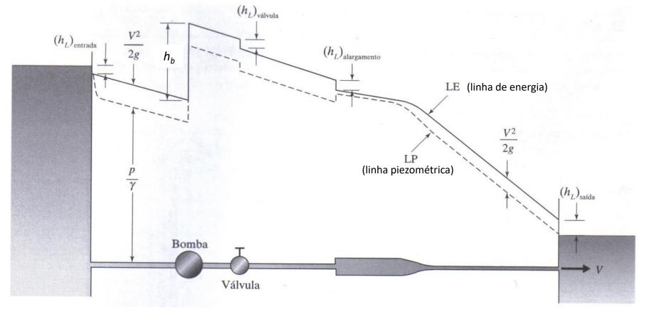
A bomba da Fig. é usada para aumentar a pressão de 0,2 m³/s de água de 200 kPa para 600 kPa. Se a bomba tem uma eficiência de 85%, qual a potência elétrica de que a bomba necessita? A área de saída fica 20 cm acima da área da entrada. Suponha que a área de entrada e de saída sejam iguais.
